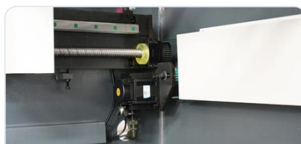
Guías lineales Movimiento suave y preciso del tope trasero.
