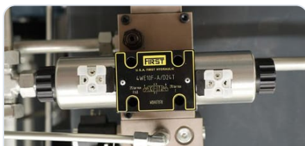
Bloque de válvulas Bosch Rexroth Hidráulica alemana, con cambio automático de velocidad.
