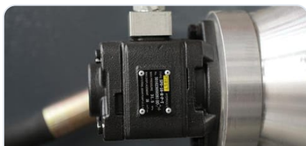
Bomba hidráulica Cilindrada de la bomba: 20 cm 3 /rev.
