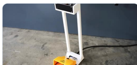
Pedal KACON con joystick Mueve Z1/Z2 sin soltar la pieza.
