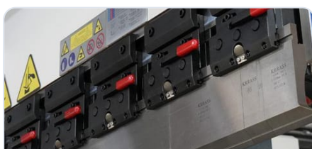
Sujeción rápida Cambio de punzones en segundos.
