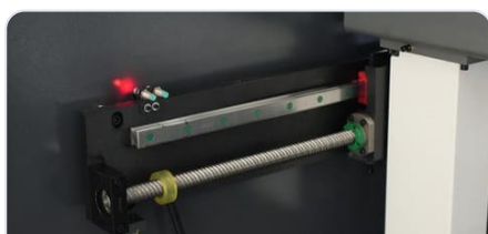
Husillo a bolas HIWIN Posicionamiento del tope con precisión de 0,05 mm.
